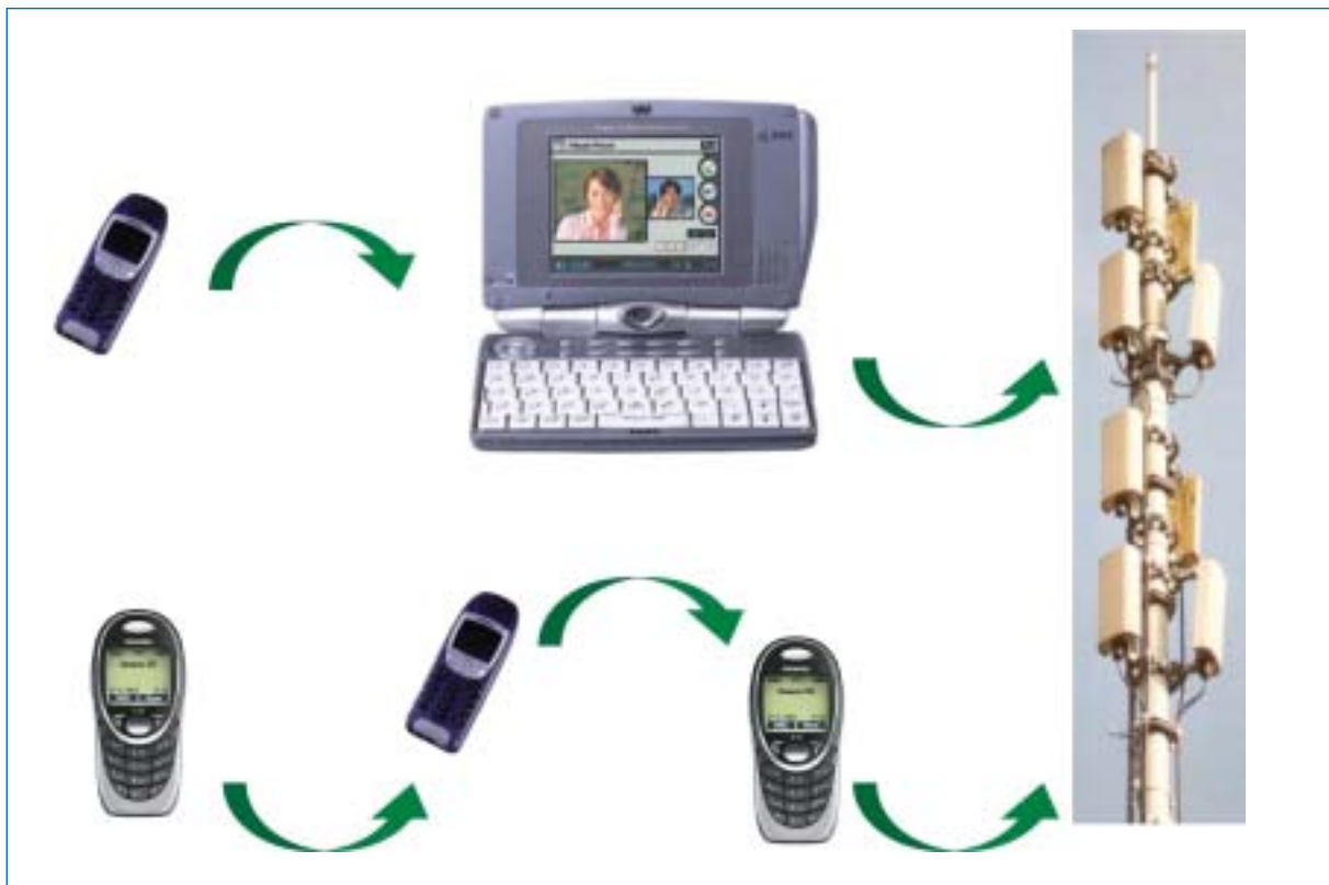
Bild 3: Reduktion der Sendeleistung durch Verwendung multi-hop-fähiger Endgeräte. Aufgrund geringer Distanzen zu einem benachbarten Endgerät wird nur eine kleine Sendeleistung benötigt.
